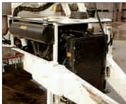
De DAF-motor zit mooi compact tussen de chassisbalken gebouwd. Bediening zit in de cabine.
