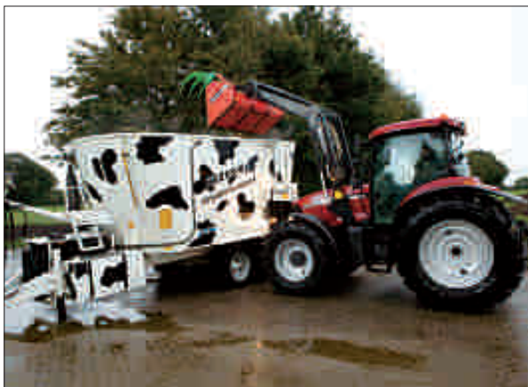
Terwijl de wagen wordt volgeladen, drijft de motor de vijzels aan.
